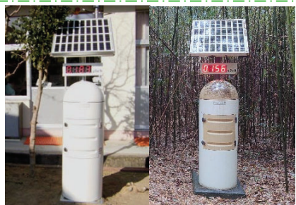
リアルタイム線量測定システム
